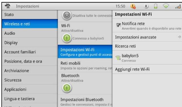
E' possibile inoltre aggiungere manualmente un rete wi-fi tramite l'opzione *“Aggiungi rete Wi-Fi”*, inserendo l'SSID di rete con rispettivo tipo di protezione.
