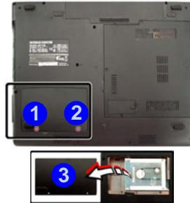
4. Rimuovere la vite e, mediante un cacciavite, fare leva delicatamente sul lettore per rimuoverlo.
