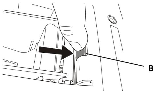
Posizionare il rotolo scontrino nuovo nell'alloggiamento rotolo, piegare l'angolo della carta (C) e inserire l'estremità del rotolo nell'apposita fessura (D). La carta è caricata automaticamente.
