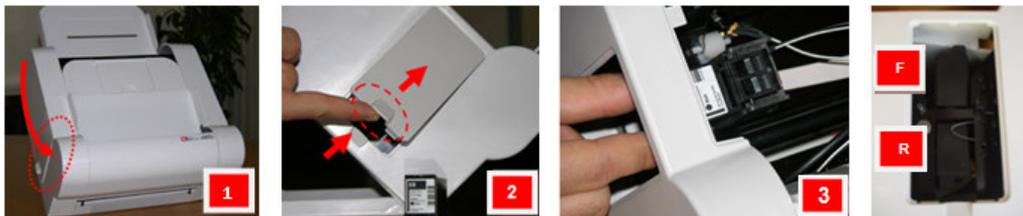
1. Individuare il vano di accesso ai moduli di stampa, posizionato nella parte laterale della scocca dello Scanner Protocollore (rif. "Aspetto esterno", capitolo 2).
