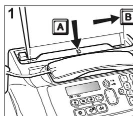
1A. Inserisci l'originale nel dispositivo d'introduzione (ADF) con la facciata da trasmettere rivolta verso il basso.
