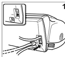
1. Per collegare il telefono d'emergenza direttamente al facsimile, rimuovi il coperchietto che copre la presa di collegamento alla linea esterna, quindi inserisci il connettore del telefono d'emergenza nella suddetta presa.
