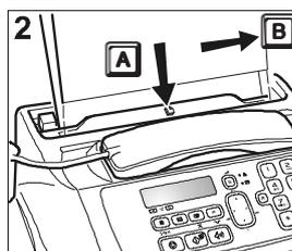
2. Inserisci l'originale nel dispositivo d'introduzione automatica (ADF) per i documenti originali con la faccia da trasmettere rivolta verso il basso (A).
