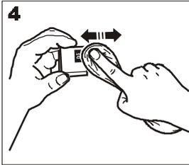
4. Die Kontaktlamellen mit einem leicht angefeuchteten Tuch reinigen.
