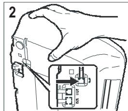
2. Stecken Sie den Stecker des Handapparatkabels in die Buchse mit dem Symbol
