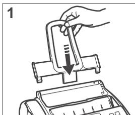
1. Stecken Sie die Papierstütze für das Druckpapier in die dafür vorgesehenen Öffnungen am Faxgerät. Schieben Sie die Papierstütze bis zum Anschlag ein.
