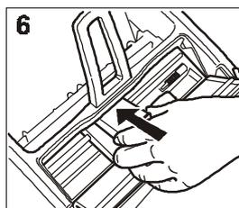
6. Setzen Sie die Druckerpatrone in ihr Gehäuse ein. Achten Sie dabei darauf, dass die Kontaktlamellen nach unten zeigen.
