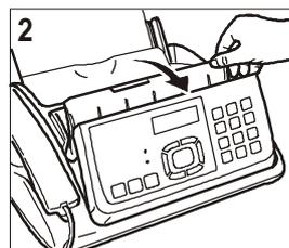
2. Heben Sie die Abdeckung der Druckerpatronenkammer mit dem dafür vorgesehenen Hebel an. Um die Druckerpatrone zu entriegeln, lösen Sie die Lasche.
