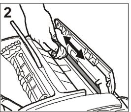
2. Das Glas des optischen Lesekopfes mit einem Tuch reinigen, das mit einem milden **Glasreinigungsmittel angefeuchtet** ist und anschließend sorgfältig abtrocknen.
