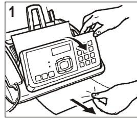
1. Klappen Sie das Bedienfeld auf, entfernen Sie das im ADF gebliebene Original und schließen Sie das Bedienfeld erneut.
