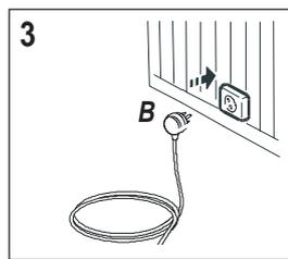
3. Stecken Sie den Stecker des anderen Kabelendes in die Telefon-Anschlusssteckdose an der Wand (B).
