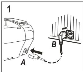
1. Stecken Sie den Gerätestecker (A) des Netzkabels in die Buchse auf der Rückseite des Geräts.
