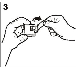
3. Die Druckerpatrone an beiden Seiten halten und aus ihrer Verpackung ziehen; dann die Schutzfolie von den Druckdüsen abziehen. Drehen Sie die Druckerpatrone so, dass die Kontaktlamellen nach unten zeigen.
