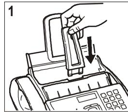
1. Stecken Sie die Papierstütze für die Originale in die dafür vorgesehene Öffnung. Schieben Sie die Stütze bis zum Anschlag ein.
