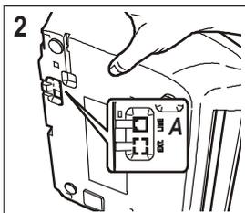
2. Stecken Sie das eine Ende des Telefonanschlusskabels in die "LINE"-Steckdose an der Unterseite des Geräts (A).
