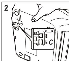
2. Entfernen Sie gegebenenfalls die Abdeckung zur Anschlussbuchse für den Telefonanschluss "EXT" am Faxgerät und schließen Sie den Stecker des Anrufbeantworters oder des Zusatztelefons an dieser Buchse (C) an.
