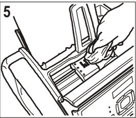
5. Die Kontaktlamellen des Druckerpatronenschlittens ebenfalls mit einem leicht angefeuchteten Tuch reinigen.
