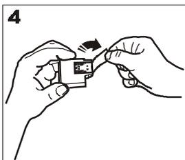
4. Die neue Druckerpatrone an beiden Seiten halten und die Schutzfolie von den Düsen abziehen.
