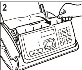
2. Klappen Sie die Abdeckung der Druckerpatronenkammer mit dem Hebel nach vorne, wie abgebildet.
