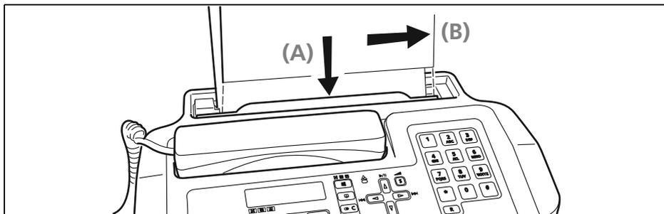
2. Après avoir inséré l'original dans le dispositif d'introduction, l'afficheur visualise le message suivant sur la ligne supérieure : *DOCUMENT PRET* . Sur la ligne inférieure, l'afficheur visualise la valeur initiale du type de contraste : *NORMAL* .
