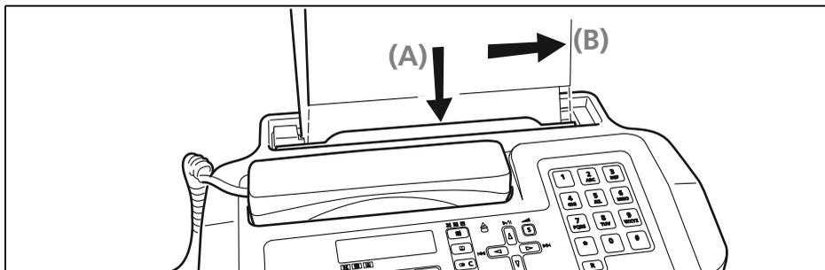
2. Cuando se ha colocado el original en el dispositivo de introducción, el visor muestra en la línea superior *DOCUM. LISTO* y, en la inferior, el valor inicial correspondiente al tipo de contraste previsto: *NORMAL*.
