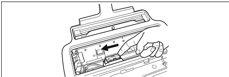
5. Desengancha el rodillo de arrastre del papel accionando la palanca, como lo indica la flecha.
