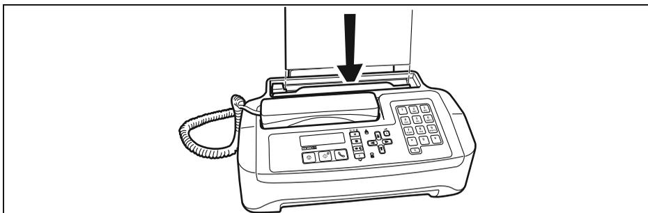
**Nota:** Si agregas hojas (máx. 40) en la bandeja para el papel (ASF), ten la precaución de colocar las nuevas **debajo** y no encima de las que quedaban. Gracias a la **memoria** de la que está dotado, el fax puede **recibir** hasta un máximo de **50 páginas (sólo el modelo base)**, incluso si no lo cargas de papel; **sólo en el modelo con contestador automático** la capacidad de 50 páginas podría reducirse, según los minutos de grabación de los mensajes presentes en el contestador automático.
