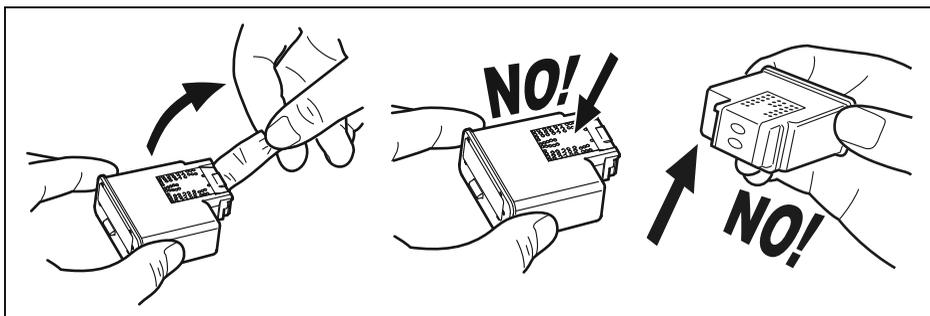
⚠ **¡Atención!** No tocar los contactos eléctricos ni los inyectores.
