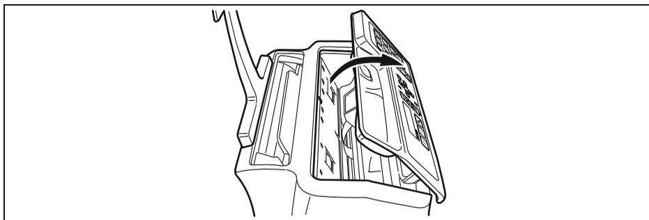
4. Desplaza el carro del cartucho hasta colocarlo en el extremo izquierdo del fax.
