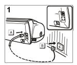
Inserisci il connettore del cavo di collegamento alla linea telefonica nella presa "LINE" sul retro del facsimile (A).
