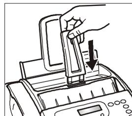
1. Montar o suporte dos originais na fenda apropriada.
