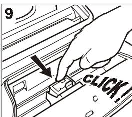
9. Popchnąć wkład aż do usłyszenia kliknięcia potwierdzającego prawidłowe wsadzenie.
