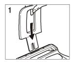
Helyezze a papírtámasztékot a neki kijelölt résbe a faxkészülék felső szélén. Nyomja befelé a támasztékot míg az szilárd pozícióba nem kerül.
