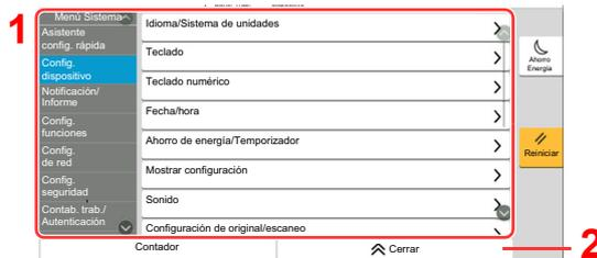
1 Muestra los elementos del Menú Sistema. Los elementos no mostrados se pueden mostrar deslizando la pantalla arriba y abajo.
