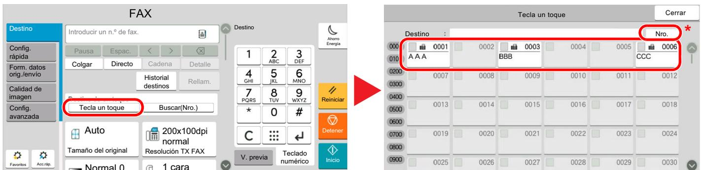
\* La tecla [**Nro.**] tiene la misma función que [**Buscar(Nro.)**] en el panel digital. Úsela para introducir directamente un número con el teclado numérico, por ejemplo, para especificar una dirección de transmisión con un número de tecla de un toque o para llamar a un programa almacenado con el número de programa. Para obtener información sobre los números de teclas de un toque, consulte:
