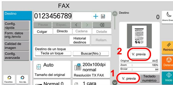
La máquina empieza a escanear el original. Una vez completado el escaneado, aparece la vista previa de la imagen en el panel.
