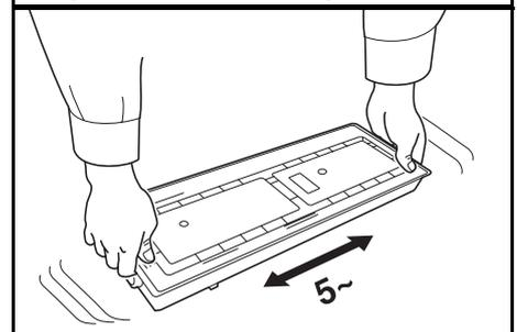
Setzen Sie einen neuen Tonerbehälter ein. Drücken Sie den Behälter sanft mit beiden Händen, bis er einrastet.
