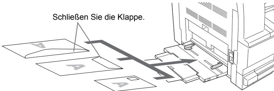
**WICHTIG:** Wie Sie die Briefumschläge einführen (Ausrichtung und bedruckbare Seite) hängt vom Typ des Briefumschlags ab. Achten Sie darauf, dass Sie die Briefumschläge richtig einlegen, da sonst der Druck in der falschen Richtung oder auf der falschen Seite erfolgt.
