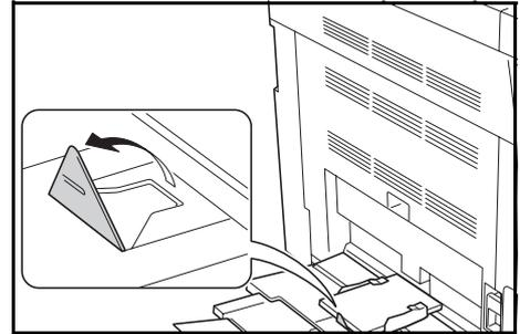
Bei Briefumschlägen im Hochformat schließen Sie die Klappe des Umschlags. Schieben Sie die Briefumschläge entlang der Breitenführungen bis zum Anschlag ein, mit der bedruckbaren Seite nach unten und mit der Klappe in Richtung des Einzugs gerichtet.
