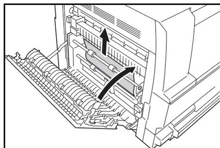
**HINWEIS:** Reißt Papier während der Staubeseitigung, sämtliche Papierteile aus dem Geräteinnenraum entfernen.
