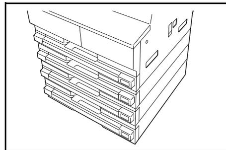
**HINWEIS:** Das 18-S./min-Modell kann mit drei zusätzlichen Kassetten, das 22-S./min-Modell mit zwei zusätzlichen Kassetten ausgestattet werden.
