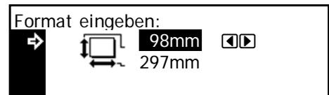
**5** Mithilfe der Tasten **<** oder **>** die Länge eingeben (148 - 432 mm).
