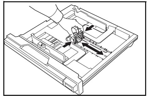
Bei A3 (11 x 17 Zoll (Ledger))-Papier die Längenführung ganz nach rechts schieben und nach unten drücken.
