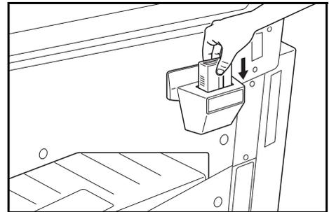
**HINWEIS:** Wenn das Zählermodul installiert ist, können nur dann Kopien erstellt werden, wenn auch der Zähler im Gerät eingesetzt ist.
