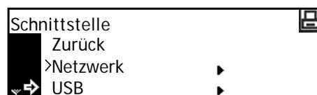
**5** Mithilfe der Pfeiltasten **▲** oder **▼** die Option *TCP/IP* auswählen und die Eingabetaste drücken.
