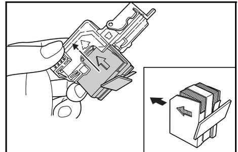
Magazin in die Magazinhalterung einsetzen und den Papierstreifen vom Magazin abziehen.
