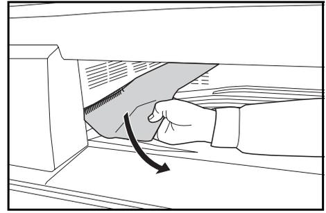
**HINWEIS:** Reißt Papier während der Staubeseitigung, sämtliche Papierteile aus dem Geräteinnenraum entfernen.
