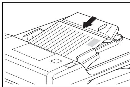
**WICHTIG:** Zur Vermeidung von Fehleinzügen darf der Originalstapel die Maximalmarkierung an der hinteren Führung nicht übersteigen.
