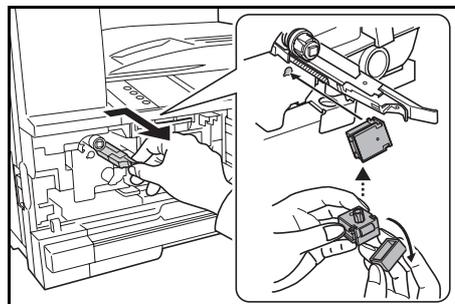
Gitterreinigungselement in das Gerät einsetzen.
