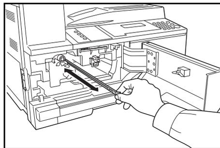
Gitterreinigungselement auspacken und Kappe abnehmen.
