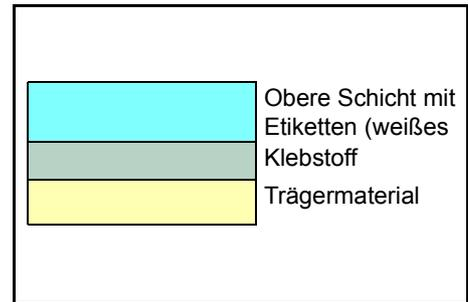
Zwischen den einzelnen Etiketten auf der oberen Schicht dürfen keine Abstände sein. Befinden sich zwischen Etiketten Abstände, so besteht die Gefahr, dass sich Etiketten lösen und ernsthafte Stauprobleme im Gerät verursachen.
