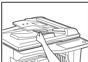
Se non è possibile rimuovere con facilità la carta inceppata dall'area di uscita, aprire la parte mobile del vassoio dell'alimentatore di originali e rimuovere l'originale.
